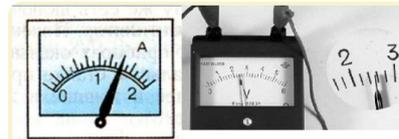
По показаниям приборов определите сопротивление проводника.
